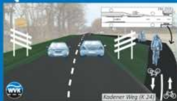
Ortsausgang Kadener Weg (K 24) mit Baumtoren (beidseitig) und Fahrbahnverschwenkung zur fahrdynamischen Geschwindigkeitsreduzierung
